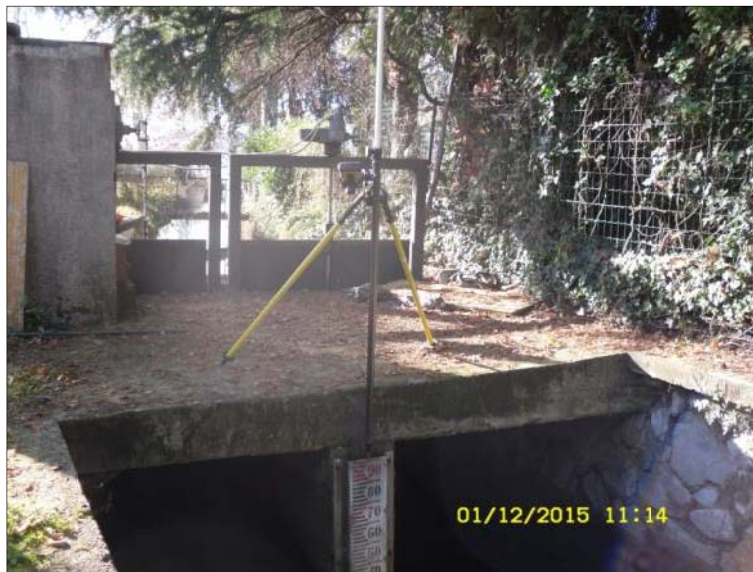
Foto 2: dettaglio livellazione asta Torrente Acquanegra
